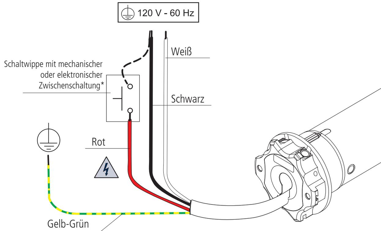
Wenn nicht gebraucht, roten Draht isolieren. Es ist gefährlich, den roten Draht zu berühren, wenn der Motor unter Strom ist.
